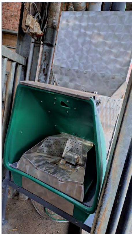
□ Zařízení na měření emisí metanu na stanici v Athu (foto: Kamil Malát)
